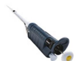
**Pipetman P5000 y P10 ml.** Estos modelos son ideales para la dispensación de grandes volúmenes de fluidos acuosos de viscosidad moderada y densidad. Están equipados con un filtro de polietileno que prolonga la vida útil del cilindro y evita la contaminación. Las pipetas **5 ml y 10 ml** no poseen expulsor de puntas.
